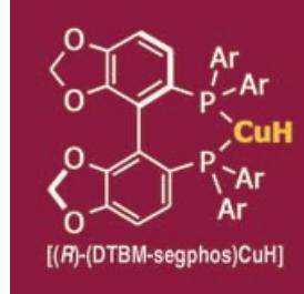
**Auf die Flasche gezogen:**  $\{[(R)\text{-DTBM-segphos}]\text{CuH}\}$  (siehe Formel; DTBM = 3,5-Di-*tert*-Butyl-4-methoxy), das *in situ* hergestellt wird, ist das erste Kupferhydridoreagens, das gelagert und längere Zeit ohne Aktivitätsverlust bei einer Reihe von asymmetrischen Hydrosilylierungen eingesetzt werden kann.
